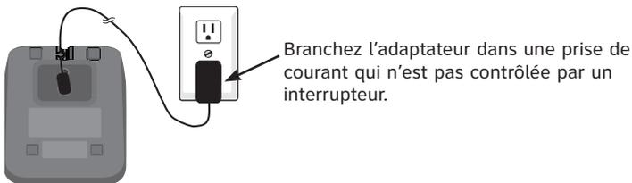
Branchez l'adaptateur dans une prise de courant qui n'est pas contrôlée par un interrupteur.
