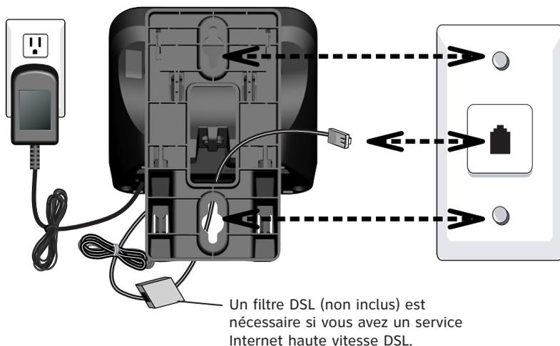
5. Alignez les ouvertures du support avec la plaque téléphonique et glissez le support de fixation vers le bas pour le verrouiller en place. Enroulez et attachez le fil du téléphone et le fil de l'adaptateur à l'aide d'une attache torsadée.
